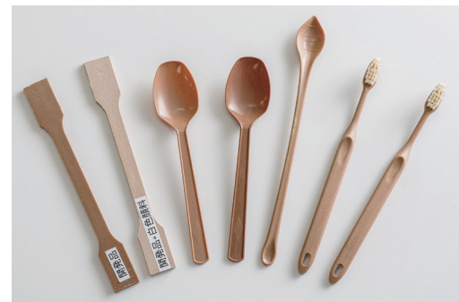
成形例 開発した生分解性材料で、スプーンや歯ブラシなどを試作し、成形性や強度などを評価。
