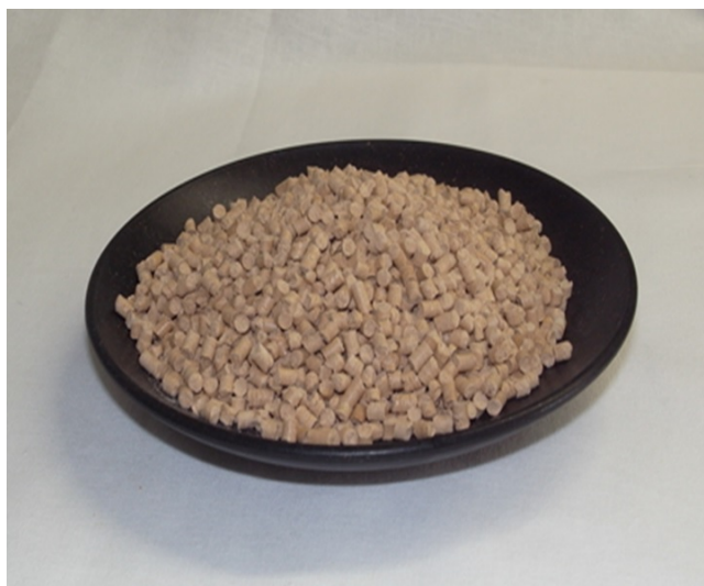
写真2 木粉を51%含むポリプロピレンのペレット外観
