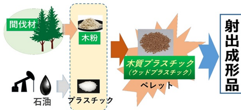
図1 ウッドプラスチックの原料から射出成形品まで
