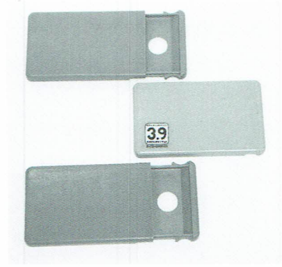
図6 精密成形品（カードケース），ヒノキ粉31wt%
