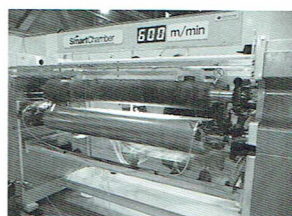
左/キャストフィルム成形用Tダイ。空圧駆動による動作を見せていた。右/密閉式のACコーター。デモのため水による高速運転をしていたがまったく水漏れしない
