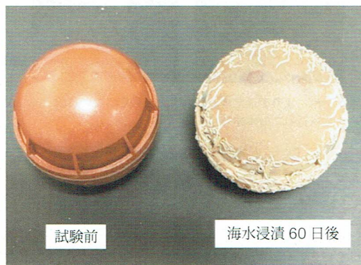
図8 浮き玉モデルと海水浸漬試験
